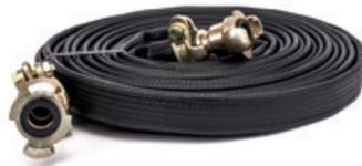
Syntax Universal Pressluftschlauch. Gewebe aus 100% hochfestem Polyester. Extrem hohe Abriebfestigkeit. UV-beständig. Temperaturbereich: -40 °C bis + 100 °C. Platzdruck: 50 bar. Einsatzbereich: Baugewerbe.
