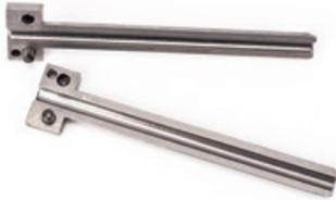
Schlitzbuchse für Rohreinblaskolben. Zum Einblasen von Stahlseilen und Kunststoffseilen von  $\varnothing$  4 bis 8 mm. Teilbare Schlitzbuchse zum Schutz des Gummikolbens während dem Einblasvorgang. Schlitzbuchse muss dem Seildurchmesser angepasst sein um unnötigen Luftaustritt zu vermeiden. Stahlkonstruktion. Verzinkt.
