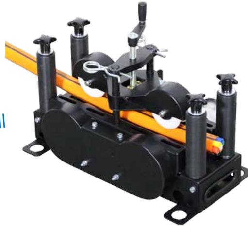
Katimex Kabelvorschubgeräte werden eingesetzt um die bei einem Kabelzug auftretenden Zugkräfte zu reduzieren und dadurch das Kabel zu schonen. Sie können immer dann zum Einsatz kommen wenn die errechneten Zugkräfte des Kabels über denen vom Hersteller angegebenen Maximalwerten liegen.
