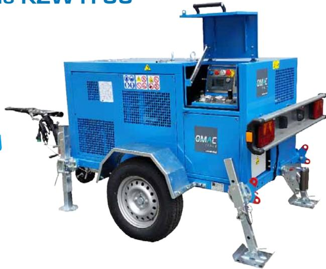
Einsätze im Kabeltiefbau verlangen von den Maschinen ein Höchstmaß an Sicherheit und Zuverlässigkeit. Für die unterirdische Verlegung von Kabeln, Glasfaserleitungen und Rohren wurde die **Kabelziehwinde KZW-H** entwickelt. Sie zeichnet sich durch kompakte Bauweise und hohe Zugkraft aus.
