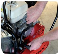
Wenn mit unterschiedlichen Seildurchmessern gearbeitet wird oder das vorhandene Seil durch ein weiteres verlängert werden muss, entfällt durch einfaches Auswechseln der Haspel ein aufwändiges Umspulen. Hierzu bieten wir selbstverständlich zusätzliche Ersatzhaspel als Erweiterung an.
