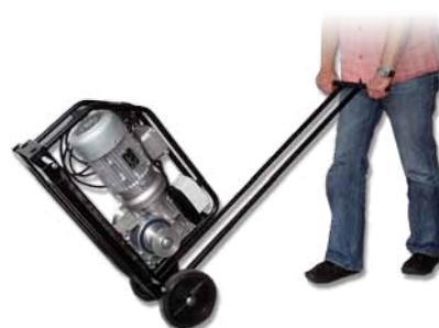
Die Umlenkhilfe ist für alle Katimex Spillwinden der KSW-E Serie geeignet. Sie dient der Unterstützung bei Kabelzügen und ermöglicht eine formschlüssige Anbindung von Winde und Kabelausslass.
