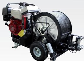
Die leicht herausnehmbare Seiltrommel ermöglicht das Wechseln der Haspel selbst auf der Baustelle ohne Werkzeug in wenigen Sekunden. Gründe für den Wechsel der Haspel können das Verlängern des Stahlseils sein oder der Wechsel zu einer anderen Seilstärke.
