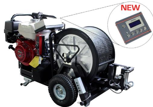
Die Hilfsseilwinden der Serie HSW-B 750 sind bestens geeignet, um schwere Windenseile großer Kabelziehwinden mit hoher Zugkraft in Leerrohre oder Kabeltrassen einzubringen. Selbstverständlich können auch leichtere Energie- oder Telekommunikationskabel über weite Strecken eingezogen werden. Durch die Zugkraftabschaltung können sogar Fernmeldekabel ohne Risiko verlegt werden. Die Zugkraftaufzeichnung mit Protokollierung erbringt den von Auftraggebern immer häufiger geforderten Mess-Nachweis.
