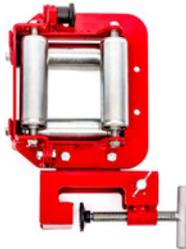
4 hochbelastbare, dickwandige Stahlrollen. Mit Universalhalter zur Befestigung an Kabelrinnen, T-Trägern oder an Rohren. 4. Rolle schwenkbar zum Einlegen der Kabel über Schnellverschluss. Vorbereitet für 5. Rolle. Rahmen pulverbeschichtet.
