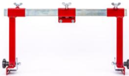
Universelle Befestigung auf Kabelpritschen von 80 bis 500 mm breite. Standardmäßig mit Traversenhalter. Zur Aufnahme der Pritschenrolle RFK Typ 55, 90, 140. Position mit Klemmschraube frei verstellbar. Rahmen pulverbeschichtet.
