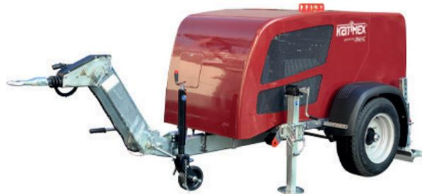
Diese Kabelziehwinde kann vielseitig eingesetzt werden und zeichnet sich durch ihre kompakte und leichte Bauweise aus. **Die KZW-UP30** besticht durch ihre enorme Leistungsfähigkeit von 30 kN maximaler Zugkraft und der hohen Geschwindigkeit von bis zu 65 m/min.
