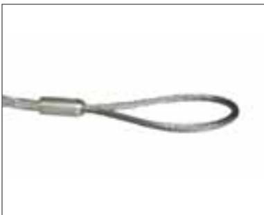
Am Strümpfanfang werden alle Litzen zusammengeführt und in einer Hülse mit einer Seilschleife verpresst. Die Presshülse ist in Zugrichtung großzügig angefast, um ein Verhaken im Rohr zu verhindern.
