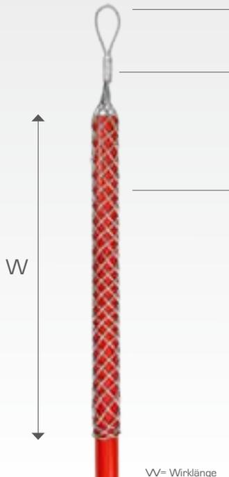
Am Strumpfanfang werden alle Litzen zusammengeführt und in einer Hülse mit einer Seilschleife verpresst.
