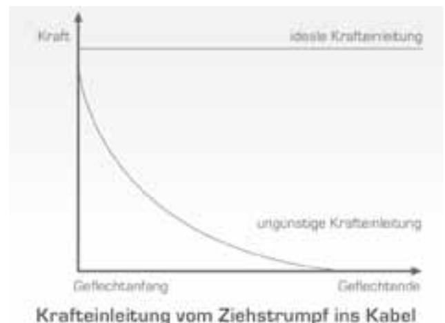
Die Qualität und Anzahl der eingesetzten Drähte kommt nur dann voll zur Geltung, wenn die Konstruktion für jede Anforderung optimiert wird. KATIMEX® bietet ein fein abgestuftes Sortiment von Zieh- und Haltestrümpfen mit optimaler Maschenweite an.
