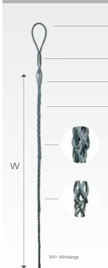
Am Strumpfanfang werden alle Litzen zusammengeführt und in einer Hülse mit einer Seilschlaufe verpresst.
