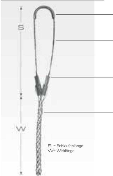
Die **Aluminiumverstärkung** der Schlaufe bietet zusätzlichen Halt bei der Fixierung.
